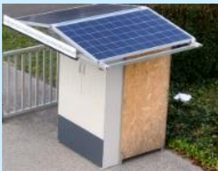
Autonomna stanica za navodnjavanje
